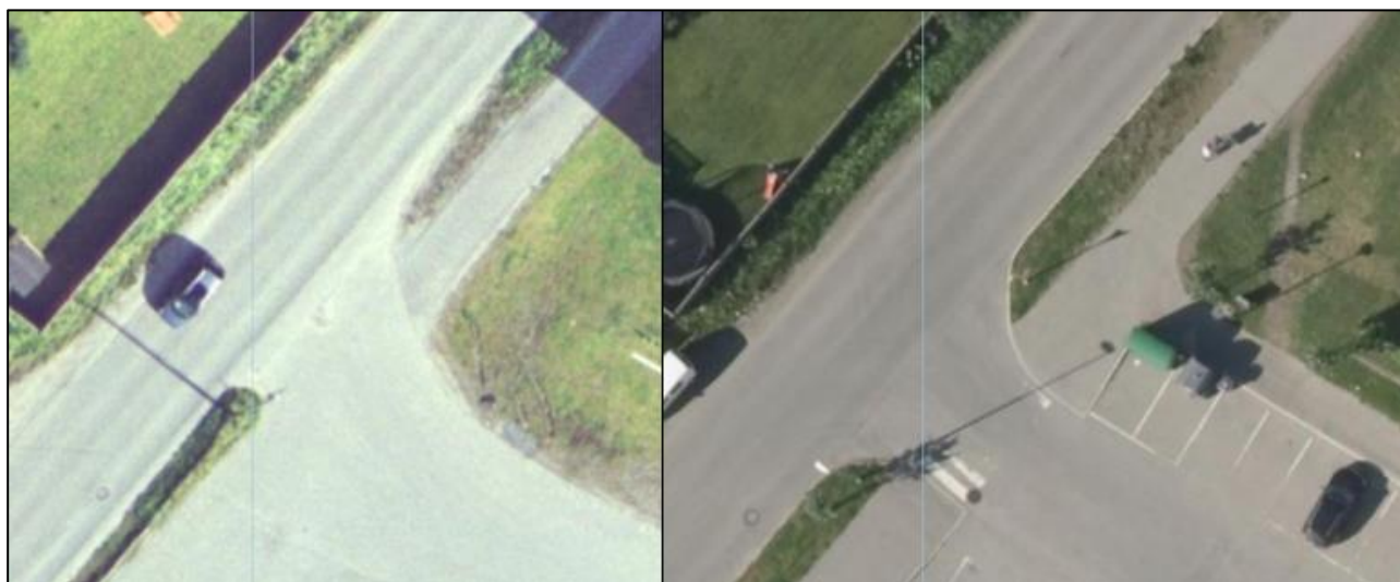
Figur 18 – Eksempel på hvordan et utflytende kryss til venstre har blitt strammet opp til høyre
