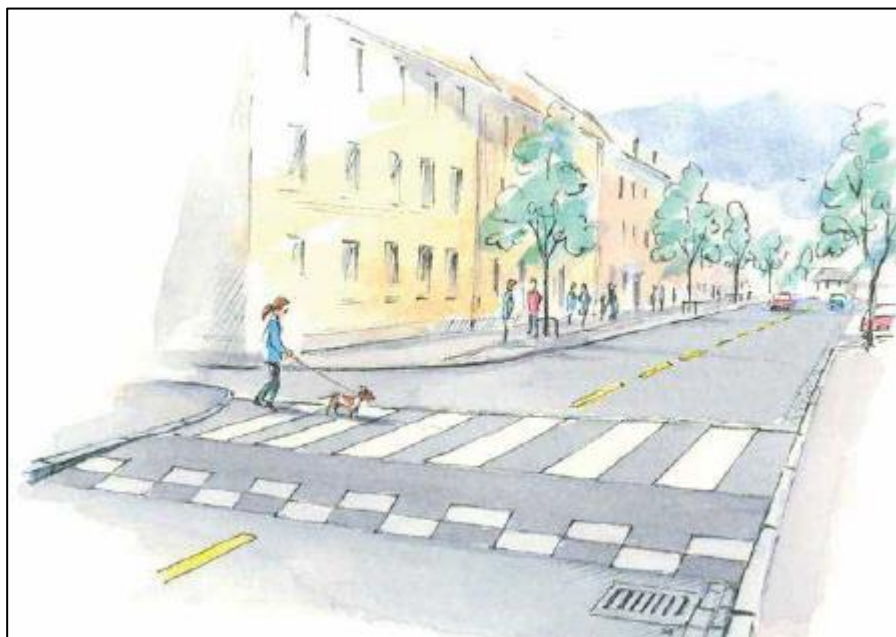
Figur 7 – Trapeshump med gangfelt (Statens vegvesen, 2017b)
